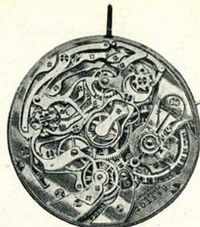
Il complicato meccanismo di un cronometro sdoppiante e riprendente.
