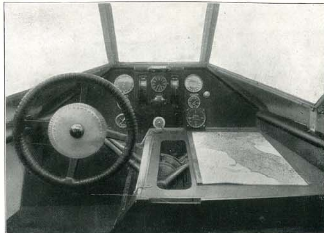
Il semplice e pratico dispositivo del Comandante De Bernardi, che congloba nel volante unico i comandi di direzione e di profondità.
